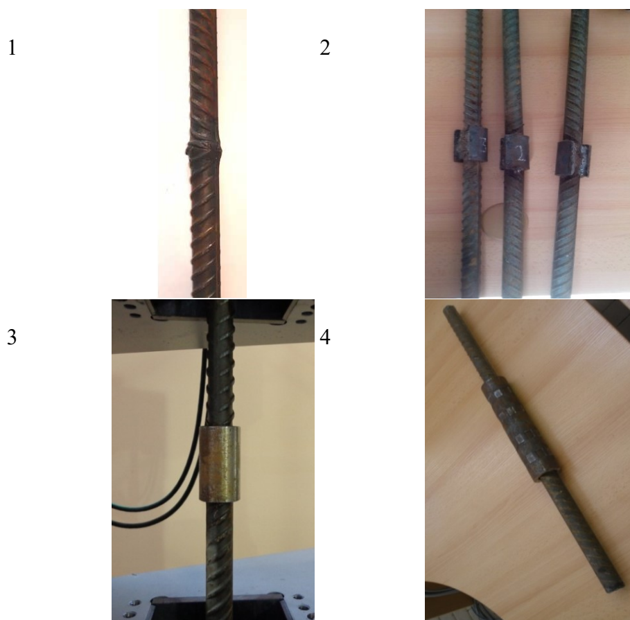
Рис. 2. Внешний вид сварных и механических соединений арматуры: 1 – сварные стыковые соединения, выполненные в инвентарных формах; 2 – сварные стыковые соединения, выполненные на стальной скобе-накладке; 3 – механические стыковые соединения с резьбовыми муфтами; 4 – механические стыковые соединения с опрессованными (обжимными) муфтами.
