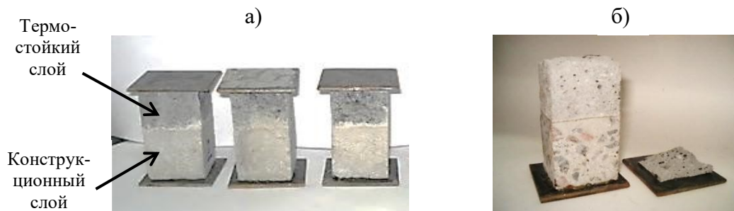
Рис. 6. Состояние контактной зоны двухслойных образцов до (а) и после (б) испытания на отрыв
